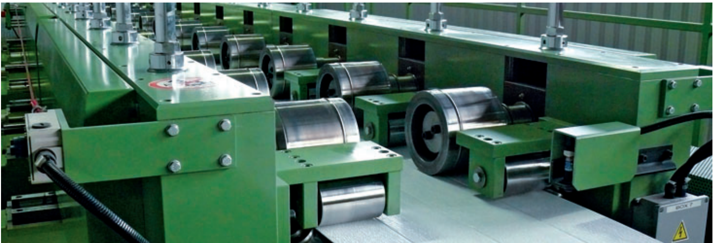
Początek produkcji paneli - kształtowanie blachy
