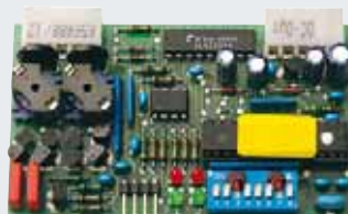
Detektor pętli indukcyjnej Nasadzana płytką obwodu drukowanego 1- lub 2-zakresowa, przystosowana na 2 oddzielne pętli indukcyjne. Dostawa nie obejmuje przewodu do pętli.
