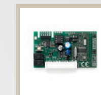
ONE.2WI 230zł 9673102 Uniwersalny odbiornik radiowy 433,92MHz, 2 kanałowy. Możliwość zaprogramowania do 512 kodów.
