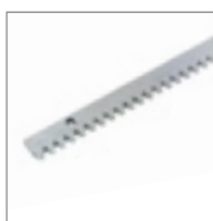
LISTWA METALOWA galwanizowana (12x30x1000 mm) z elem. mocującymi, moduł 4. Cena za metr.
