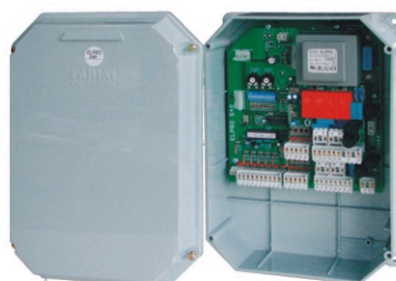
Programator elektroniczny Elpro S40 pozwalający na kontrolę do 4 słupków jednocześnie
