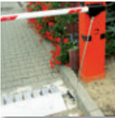
Mechaniczne połączenie kolczatki ze szlabanem.
